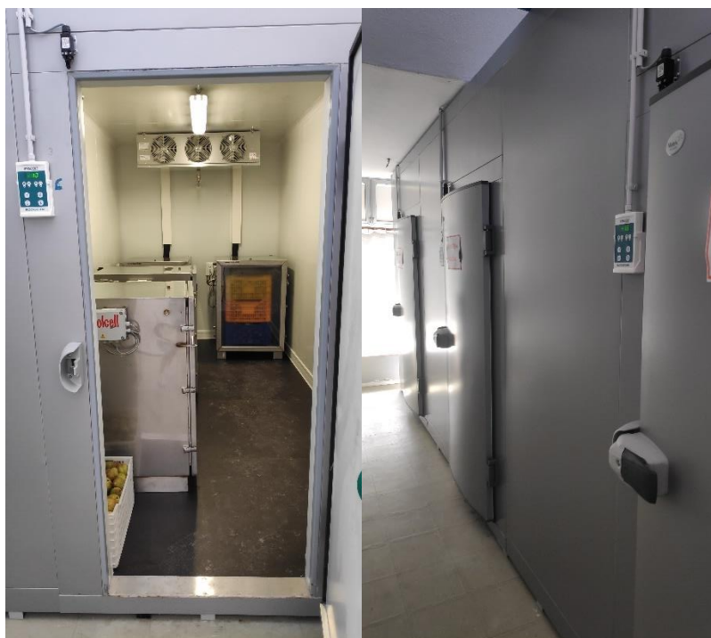
Figura 3 – Instalação piloto com câmaras frigoríficas contendo contentores, onde podem ser ensaiadas diferentes atmosferas de conservação. RochaCenter, Bombarral.
